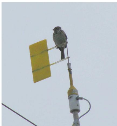
Slika 1 – Potencijalni problem kod mjerenja smjera vjetra (4)
